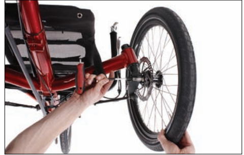
Vorderradausbau nach dem Lösen der Schraube im Endstück
