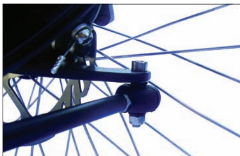
Der Gelenkkopf am Radträger wird unter den Lenkhebel montiert und durch eine Gummimanschette vor Schmutz geschützt. Oberhalb und unterhalb des Gelenkkopfes befinden sich Distanzbuchsen.
