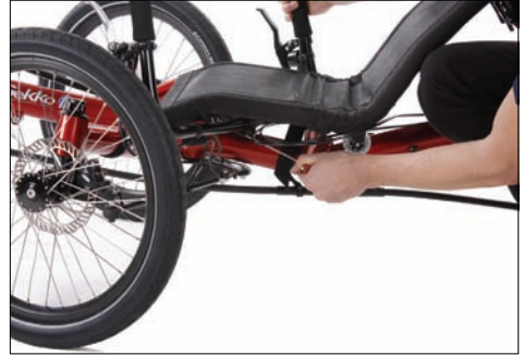
Die Verstellung von Lenkerneigung erfolgt über die Klemmung am Lenkervorbau unter dem Sitz.
