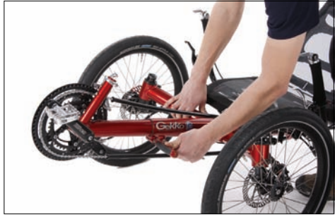
Lösen der Klemmschrauben zum Verstellen des Tretlagerauslegers.
