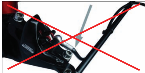
Der Bogen der Hydraulikleitung läuft vor der Spurstange: Gefahr des Abknickens (Pfeil).
